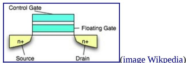
Pour écrire une donnée, on doit faire passer un courant électrique (7 V) entre les deux électrodes (drain et source) et une tension plus élevée (aux environs de 12 V) dans la grille de contrôle. L'effet *Fowler-Nordheim* implique qu'une partie des électrons qui passent entre les électrodes va se déplacer vers la grille flottante, à travers l'oxyde. Une fois la grille saturée avec des électrons, elle devient isolante et est considérée comme un 0 binaire.
